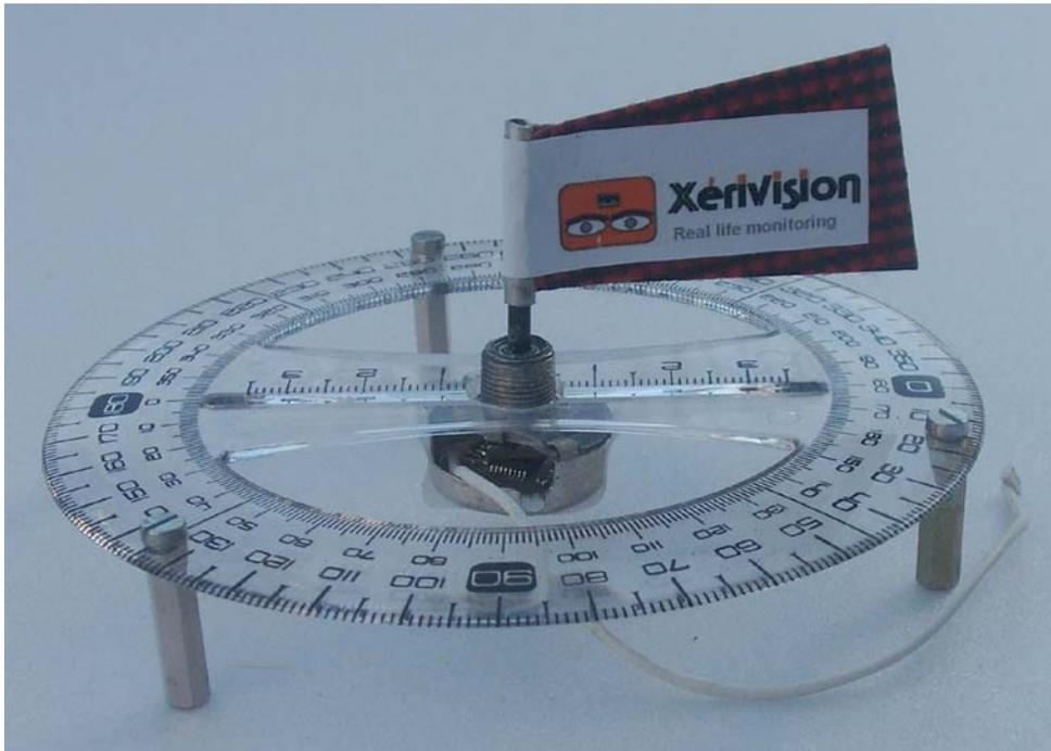
**Le capteur en lacet de Xerivision. Un drapeau monté sur roulement. Dans un boîtier de potentiomètre, un aimant lié au drapeau influence la « puce » qui va bien. Ceci est un prototype. On peut faire plus compact.**
